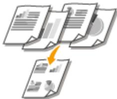
可以缩小多页原稿的尺寸，并将所有页面排列在纸张的一面上。这样可以节省纸张数，因为可以将文档复印在比原稿页数更少的纸张上。
