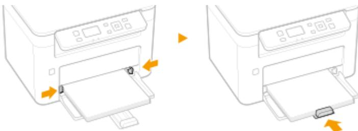
**须知:****将纸张导板完全靠紧纸张**
