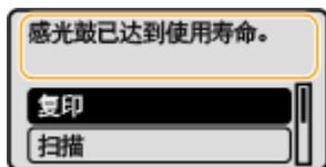
在主页画面中选择 <状态确认> ▶ <错误信息/通知> ▶ <感光鼓已达到使用寿命> 显示更换感光鼓的操作步骤。
